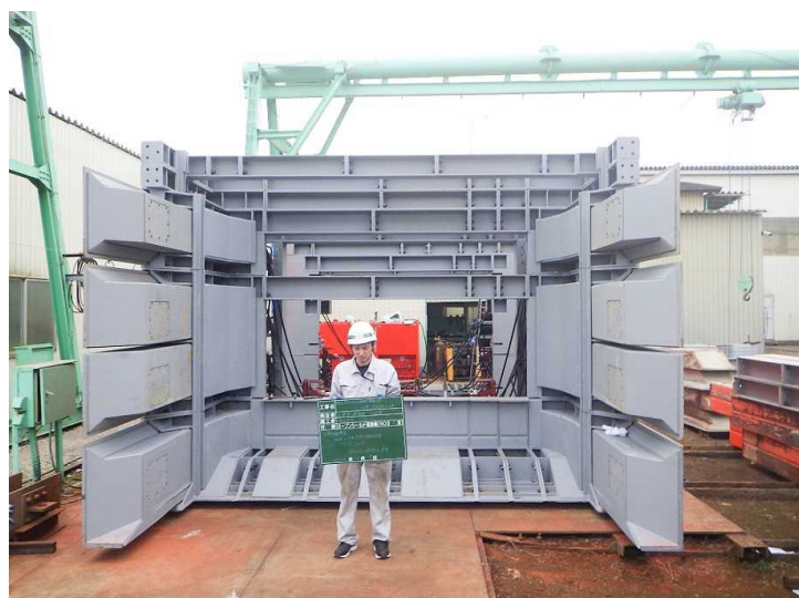
△ オープンシールド機 : 前景
